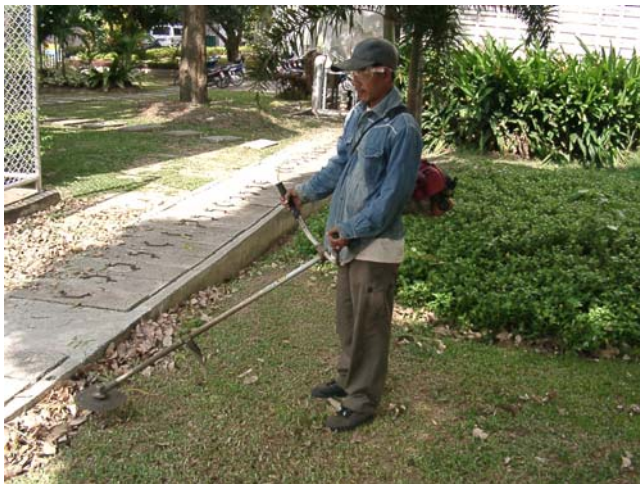
รูปที่ 1 แสดงเครื่องตัดหญ้าที่ใช้เป็นชนิดแบบใบพัดตัดที่ไม่มีตัวป้องกันการกระเด็น
