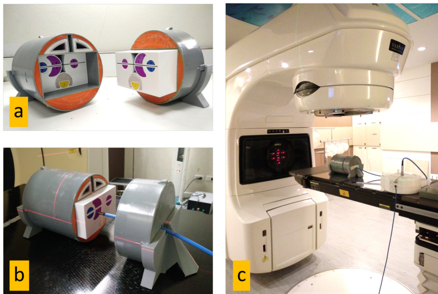
รูปที่ 3 หุ่นจำลองศีรษะและลำคอทรงกระบอก (a) การบรรจุกล่องอุปกรณ์วัดรังสีลงในลำตัวทรงกระบอก (b) การใส่อุปกรณ์วัดรังสีชนิด ionization chamber ขนาด 0.125 ลูกบาศก์เซนติเมตร และ (c) การจัดตำแหน่งของหุ่นจำลองสำหรับการฉายรังสี
