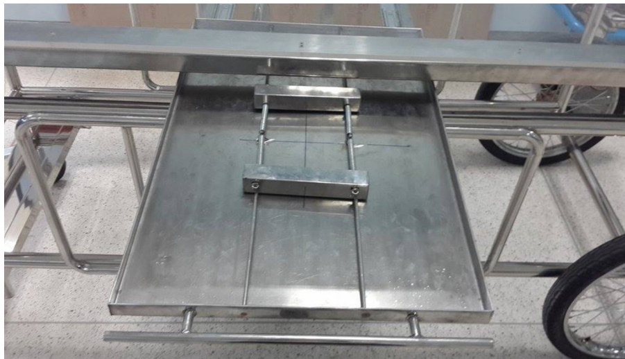
รูปที่ 6 ผลการประดิษฐ์รถเข็นผู้ป่วยนอน ส่วนถาดวางตลับฟิล์ม
