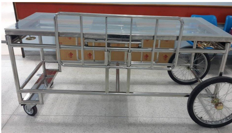
รูปที่ 4 ผลการประดิษฐ์รถเข็นผู้ป่วยนอน ส่วนโครงรถเข็น
