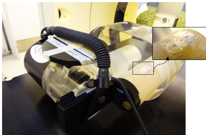
รูปที่ 2 แสดงหุ่นจำลองการหายใจยี่ห้อ Modus รุ่น QUASAR™ การติดเม็ดโลหะบนหุ่นจำลองการหายใจ
